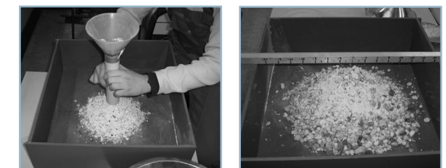
Figura 3.5.- Ensayo ángulo de reposo.
